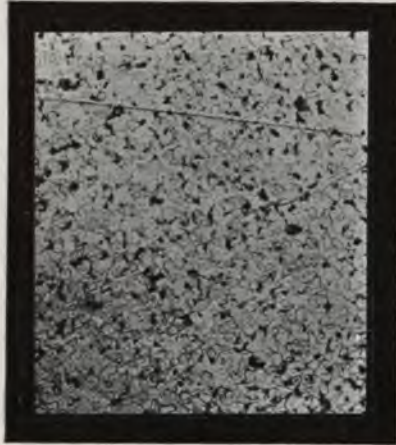
Fig. 134. Flußeisen 0,08 % C. 2 Minuten in Pikrinsäure geätzt. Die helle Grundmasse ist Ferrit, die dunkeln Flecken Perlit resp. Sorbit.
